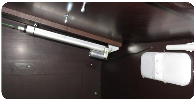
Hubzylinder für die automatische Hühnerklappe und Beleuchtung mit Dimmer
